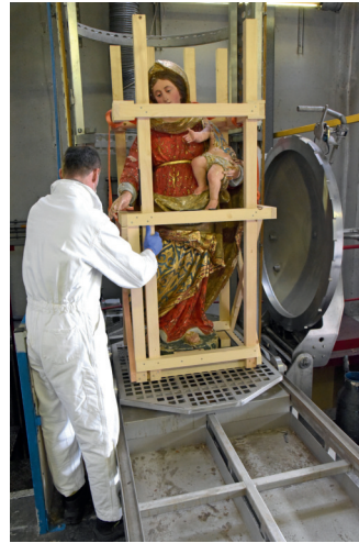
©ARC-Nucléart Imprégnation d'une Vierge à l'Enfant provenant de Beaumont-de- Lomagne, avec de la résine styrène- polyester, qui sera ensuite polymérisée par exposition au rayonnement gamma – procédé "Nuléart"
