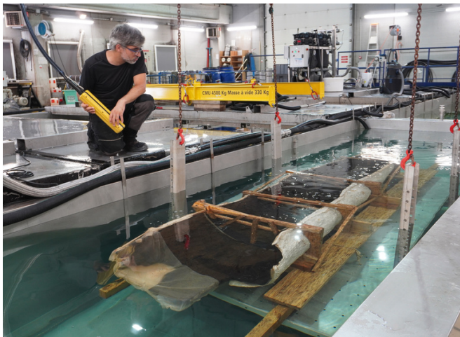
©ARC-Nucléart Mise en bain d'imprégnation de PEG d'éléments de l'épave de Grandson (Suisse)
