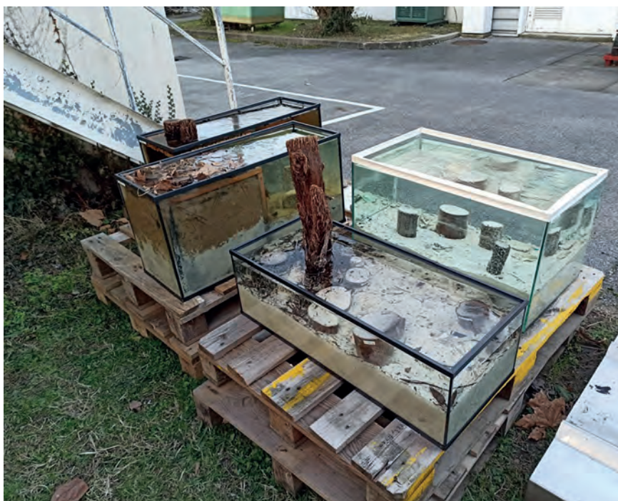
Figure 1 : Vue générale présentant les aquariums utilisés pour les essais de vieillissement.
