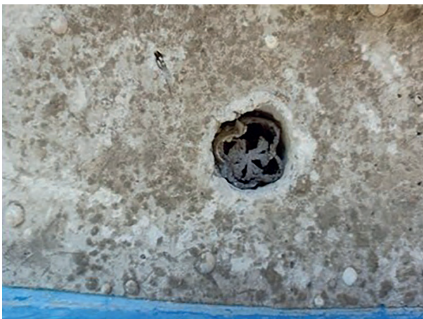
Figure 2 : Dégradation du bois induite par effondrement cellulaire du bois dans le sédiment lors d'une période de sécheresse estivale.
