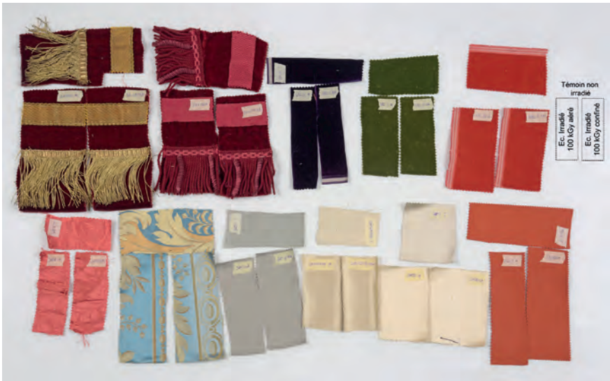
Figure 3 : Echantillons de textiles anciens irradiés et non irradiés..
