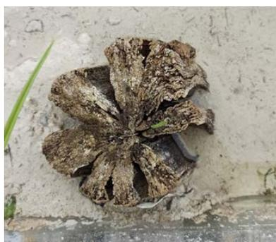
**Figure 3 : Dégradation du bois induite par effondrement cellulaire après séchage**
