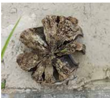
Figure 3 : Dégradation du bois induite par effondrement cellulaire après séchage
