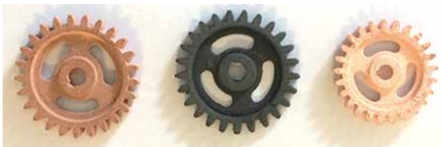
Figure 2 : Roue d'engrenage en cuivre imprimée par stéréolithographie à différentes étapes du process optimisées au préalable grâce aux échantillons réticulés sous irradiation gamma : brute, après déliantage, et après frittage, d'après Roumanie et al, SN Applied Sciences (2021) 3:55 | https://doi.org/10.1007/s42452-020-04049-3 .
