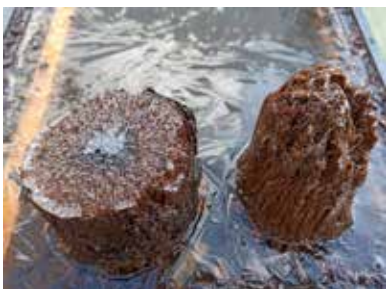
Figure 2 : Dégradation du bois induite par des cycles de gel/dégel.
