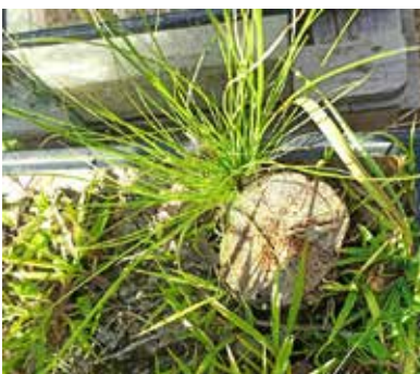
Figure 4 : Dégradation du bois induite par une infestation par les racines d'une couverture végétale.
