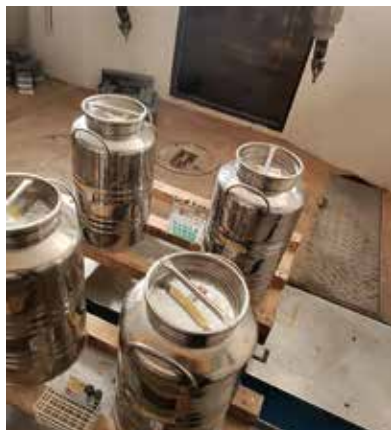
Figure 3 : Irradiation de solutions de sel métalliques (synthèse de nanoparticules) et de bidons d'eau chargés en matières organiques pour stérilisation.
