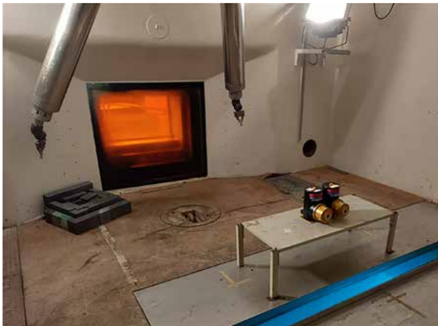
Fig. 1 : Capteurs infrarouges avec leur cryostat en cellule d'irradiation
