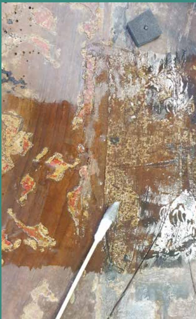
Le démontage de l'ensemble s'est révélé complexe du fait de la grande différence de résistance mécanique au sein même des fragments de noyer mais aussi, entre les fragments qui étaient dans des états de conservation très variables, face à des fixations (collages et visserie) solidement ancrées dans le doublage.
