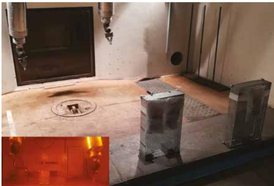
**Fig. 2** Traitement par chaleur sèche à 95°C réalisé dans l'étuve d'ARC-Nucléart. Entre deux cycles de traitement, les masques étaient ré-humidifiés en chambre climatique à 37°C et 85% d'humidité relative pendant 1 heure.
