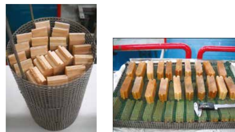
Figure 1 : Échantillons de bois avant (à gauche) et après traitement (à droite) selon le procédé Cigal®.
