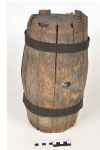
Seau consolidé par le monomère acrylique HPMA à 80 % dans l'acétate d'éthyle
