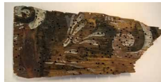
Fragment de bois polychromé consolidé par la résine sans styrène Advalite®
