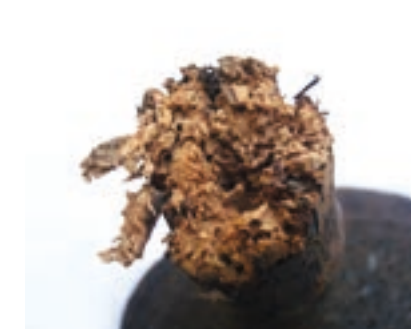
Tabouret avec un pied très dégradé, avant traitement
