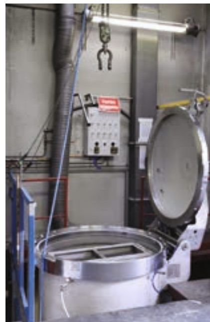
Nouvel autoclave en inox pour l'imprégnation de résine styrène-polyester
