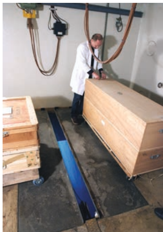
Positionnement des caisses et mise en place de dosimètres en cellule d'irradiation
