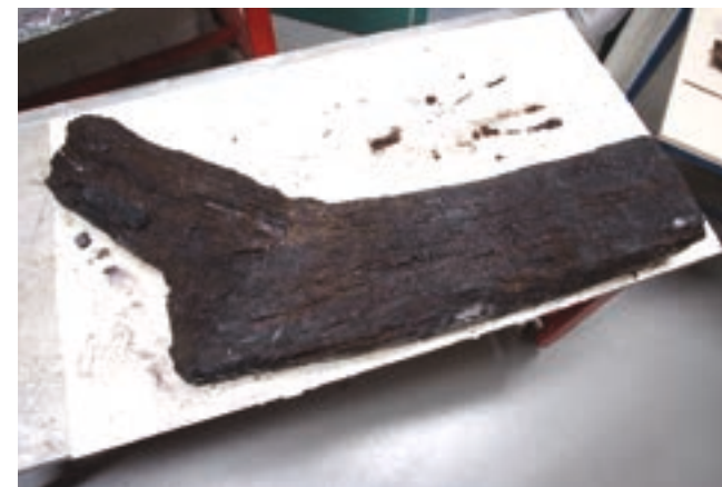
Figure 2 : Élément de vaigrage en bois extrêmement dégradé provenant des fouilles de Marseille Jules-Verne
