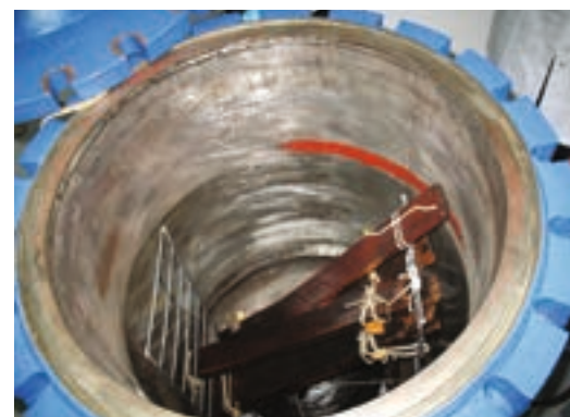
Introduction des douelles de la baratte dans la cuve d'imprégnation, opération supervisée par K. Tran
