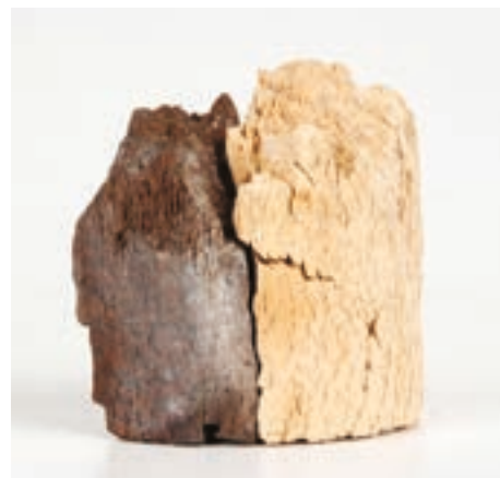
Figure 1 : Échantillons de bois archéologiques très dégradés : à droite, fragment de référence après séchage par lyophilisation ; à gauche, fragment lyophilisé puis imprégné à saturation et séché à l'air libre
