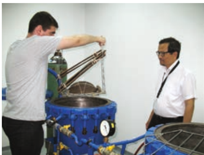
Introduction des douelles de la baratte dans la cuve d'imprégnation, opération supervisée par K. Tran
