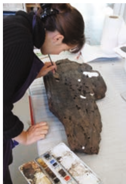
Retouches colorées du comblement actif de la rame-gouvernail des Laurons
