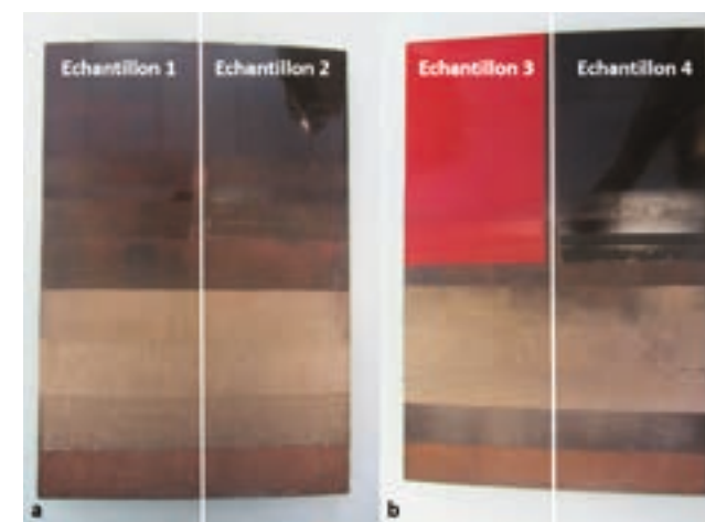
Plaques échantillons en bois laqué. Par recouvrement partiel, chaque plaque laisse apparaître les différentes couches, depuis celles de préparation (en bas) jusqu'aux couches de finition (en haut). Par division de chaque plaque, on a 4 types d'échantillons, notés de 1 à 4 qui se différencient par les couches de préparation sur chanvre (1 et 2) ou sur tarlatane (3 et 4) et les couches de finition : laque + huile siccativante (1), laque pure (2), laque + cinabre (3) et laque + oxyde de fer (4).
