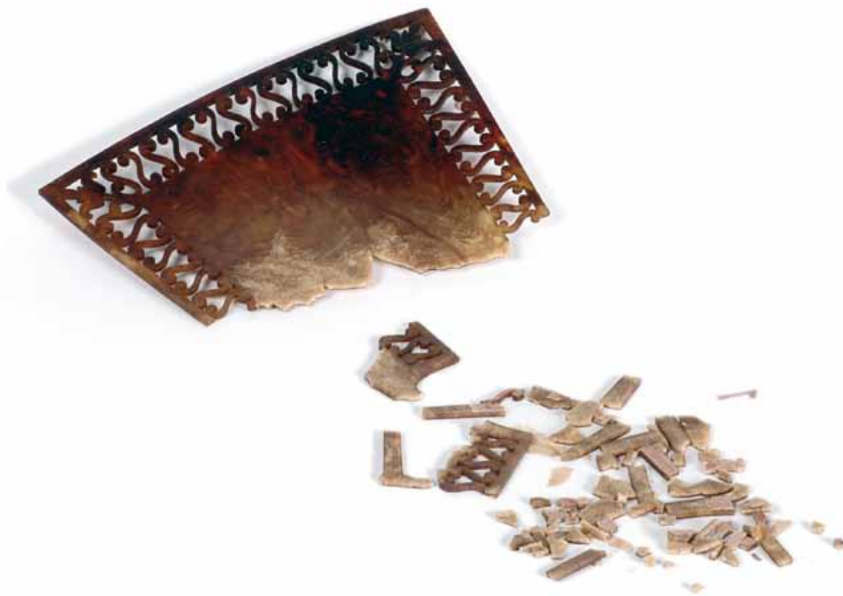
Plaque ornementale en celluloïd complètement dégradée
