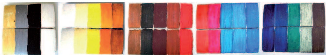
Tenue des couleurs à l'irradiation : en bas, les échantillons référencés non irradiés ; en haut, les échantillons irradiés à une dose de 200 kGy.
