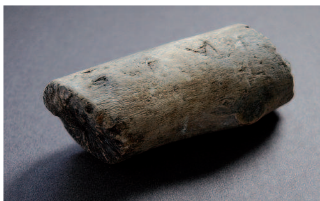
Fragment de branche très dégradé traité au di-acide azélaïque et séché à l'air ne présentant aucune fissure, notamment radiale très courante dans ce type de géométrie.
