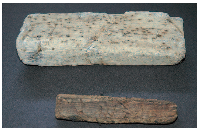
En haut, fragment de bois ouvragé, traité au di-acide azélaïque et séché à l'air, avec détails de la surface. En bas, un échantillon équivalent au premier n'ayant subi aucun traitement d'imprégnation et ayant séché à l'air libre. Son volume a sensiblement diminué, par comparaison au premier, en raison du phénomène d'effondrement cellulaire.
