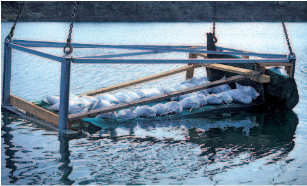
Immersion d'un tronçon de barge dans un lac.
