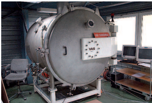
L'enceinte de traitement sous vide partiel.
