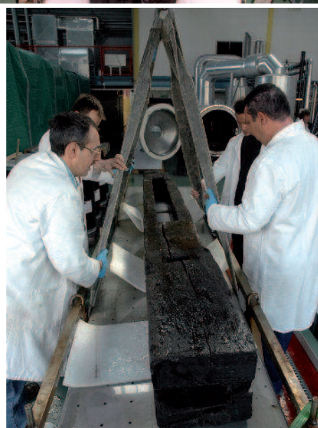
En haut, un élément du pressoir dans la cuve d'imprégnation de polyéthylène glycol. En bas, un autre élément va être introduit dans le lyophilisateur.
