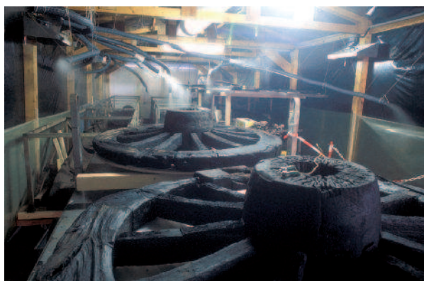
Séchage contrôlé des roues d'affût de canon.
