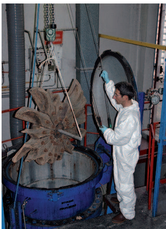
Mise de la roue en cuve d'imprégnation de résine pour consolidation.
