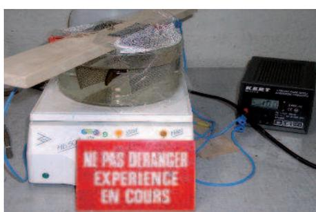
Mise en œuvre d'un traitement par électrophorèse.
