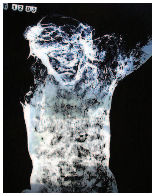
Radiographie du torse du Christ montrant l'assemblage des différentes pièces
