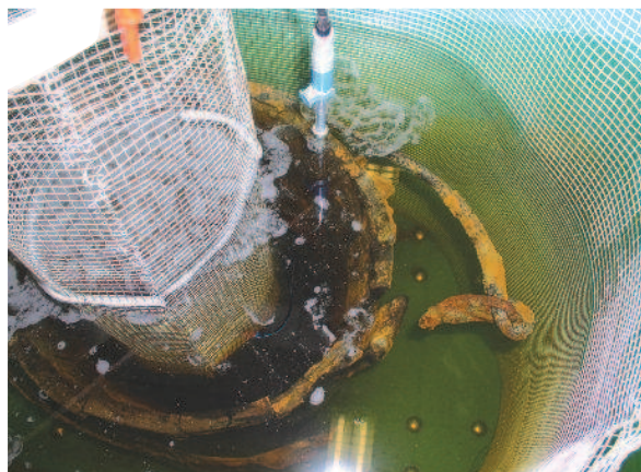
Seau provenant des fouilles de Lyon Saint-Georges dans sa cuve d'électrophorèse
