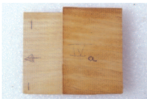
Photo montrant la stabilisation dimensionnelle induite par le traitement du bois à l'aide de résines de type carbamate
