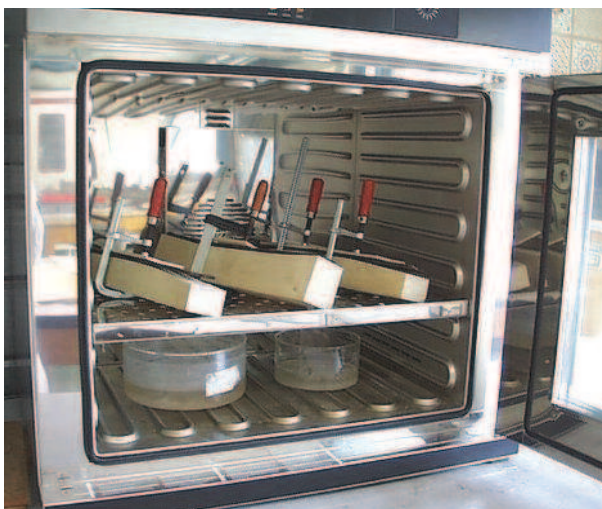
Restauration des objets provenant de La Natière : remise en forme dans une étuve des douelles du seuil NAT 876
