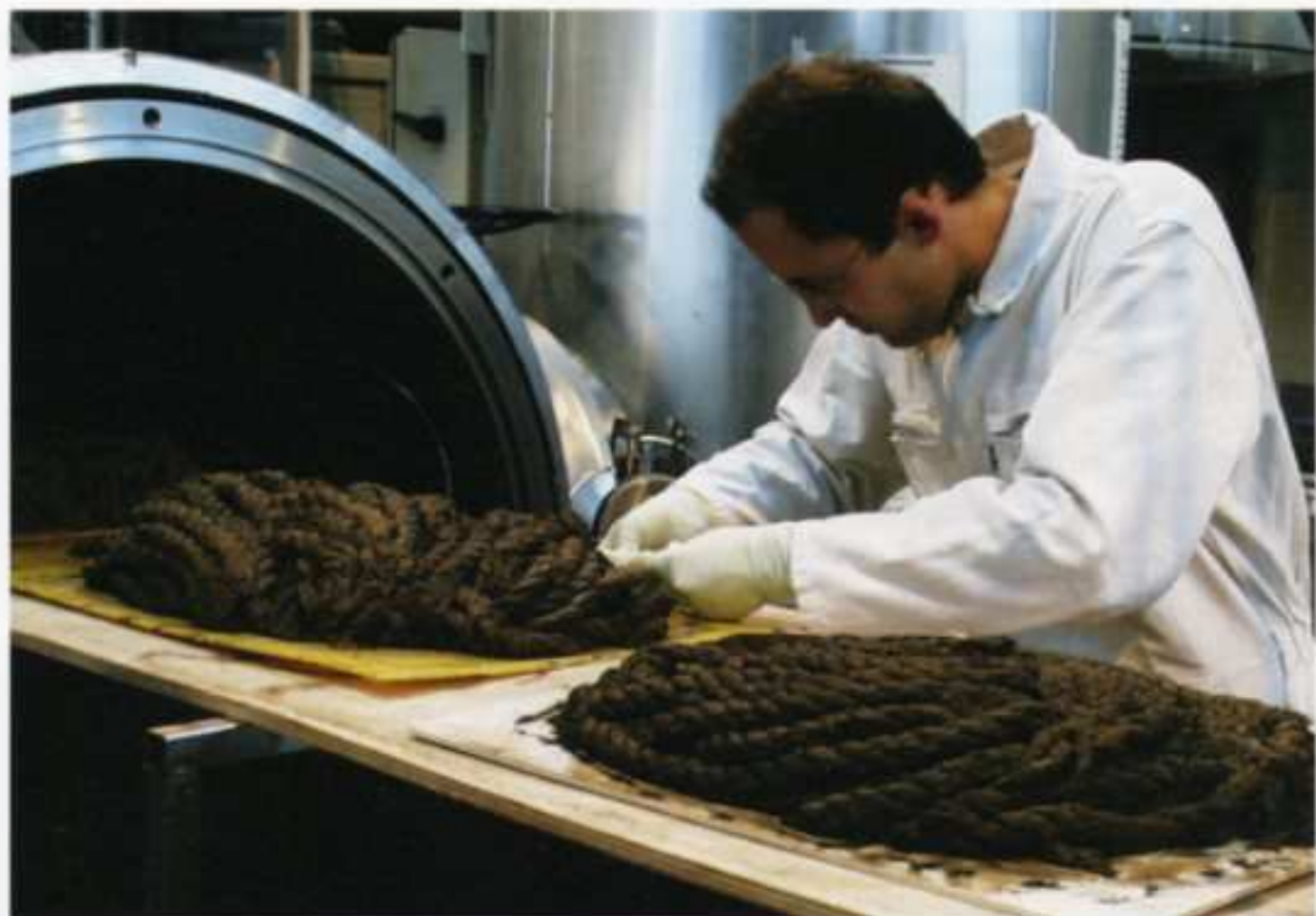
Mise en lyophilisation des cordages de l'épave de La Natière, Saint-Malo
