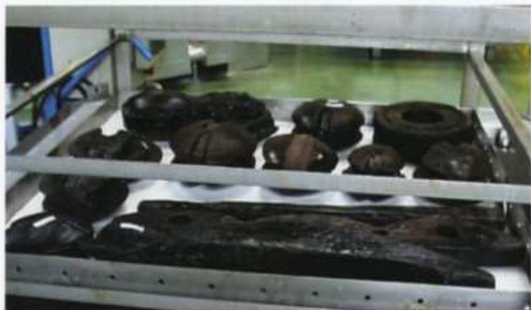
Mise en lyophilisation des cordages de l'épave de La Natière, Saint-Malo
