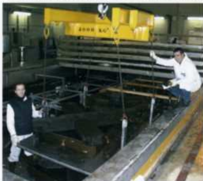
Mise en traitement des bois dans le grand bassin d'imprégnation de polyéthylène glycol
