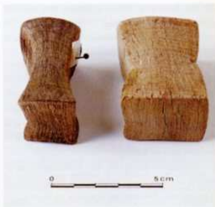
Echantillon de bois effondré à côté d'un échantillon partiellement regonflé
