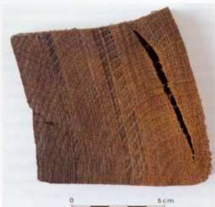
Echantillon de bois déformé car séché sans aucune précaution
