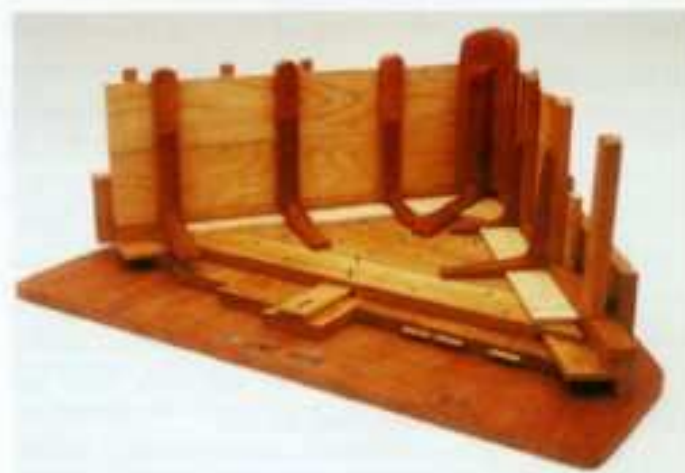
Maquette à l'échelle 1/5 e du caisson de la pile du grand pont de Saône
