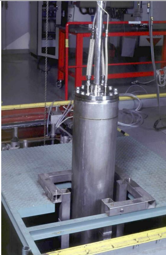
Fig. A1-9 – Conteneur INTI. Le couvercle recevant les passages électriques (pour le chauffage) et les passages de gaz (pour le contrôle atmosphérique) est entraîné dans un mouvement de rotation par un mât motorisé. Le schéma de droite propose une représentation des débits de doses calculés dans le volume d'irradiation utile pour une source C-188 de 270 TBq.
