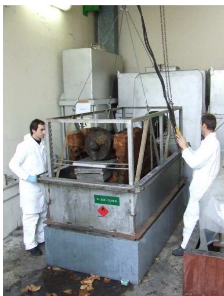
Une cuve d'imprégnation pour le traitement « Nucléart » humide
